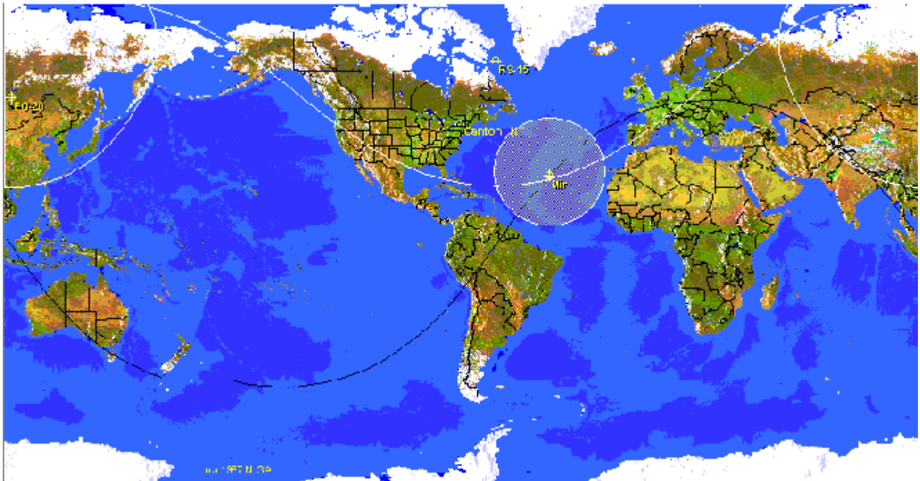
Projeção terrestre da órbita de um satélite polar de baixa altitude, a imagem sombreada a branco é o horizonte artificial ou footprint do satélite, cujo diâmetro varia com a altitude da órbita e pode ser superior a 5.000 Km.
