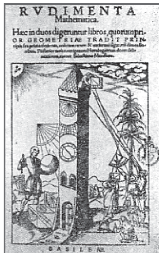
Fig. 4. Frontispício de Rudimenta Mathematica de Sebastião Münster (Basileia, 1559), onde se representam vários instrumentos usados em operações de altimetria, nomeadamente o quadrante, o quadrado geométrico e o báculo de Jacob, sendo este utilizado pelo homem figurado mais à direita
