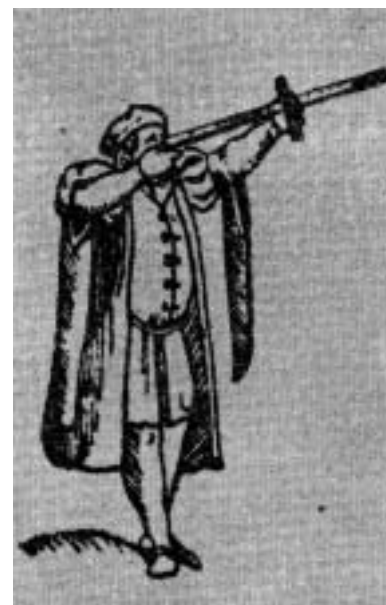
Fig. 8. Observação da Estrela Polar com a balestilha, segundo Pedro de Medina, Regimiento de Navegación
