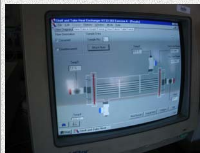
Figura 4 – Controle do processo térmico por PC
