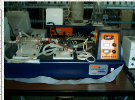
Figura 1 – Permutador de calor de feixe tubular
