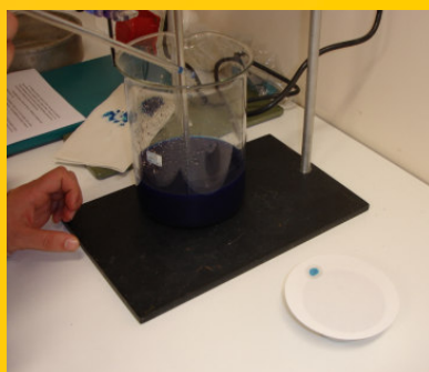
Ensaio do Azul de Metileno em agregados
